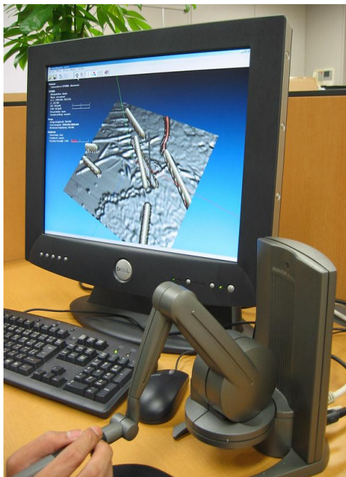
AFMプローブマニピュレーションの様子
